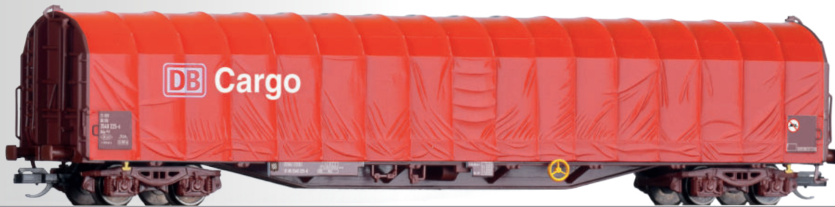
Schiebepaulenwagen Rils 652 der DB Cargo Sliding tarpaulin car Rils 652 of the DB Cargo
